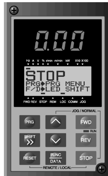
Afbeelding 3-1-2 Display van het bedieningspaneel bij het inschakelen van de voedingsspanning.
