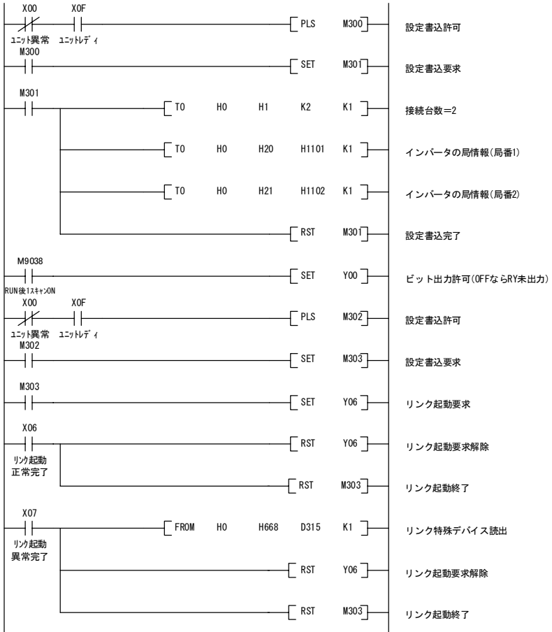
図 10.4 CC-Link 起動プログラム例 (ACPU のみ必要)
